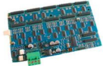
Über die optionale 10-fach Relaiskarte sind darüber hinaus komplexe Steuerungen möglich. Die LED 50 IN/OUT-Karte wird in die Peripheriegeräte bzw. in ein externes Gehäuse eingebaut.
